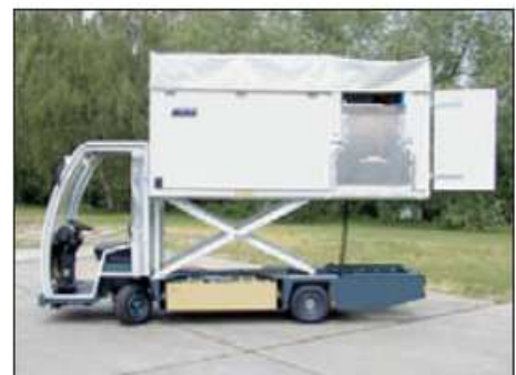
Specjalistyczny pojazd Hako-Cargo z podnoszoną hydraulicznie platformą.
