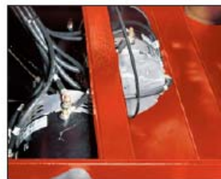
Oś napędowa z 2 silnikami elektrycznymi zapewnia optymalną wydajność.
