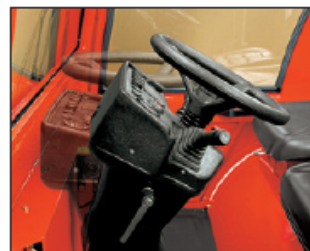
Regulowana kolumna kierownicy – swobodna pozycja kierowcy
