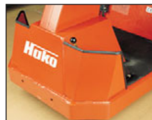
Solidna rama stalowa z mocną ochroną przed uderzeniami i ochroną stóp.
