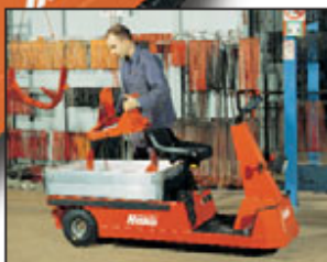
Hako-Sherpa ze specjalną platformą do przewozu części lakierowanych.
